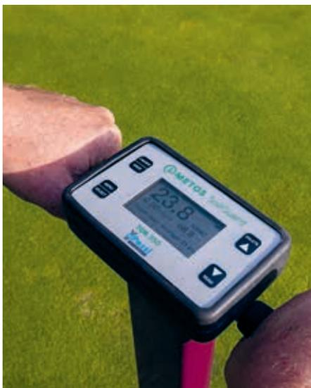
Für die manuellen Feuchtigkeitsmessungen stehen vier solcher Fieldscout TDR 300 zur Verfügung.
